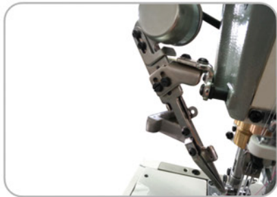
自动剪线 Auto thread trimmer
