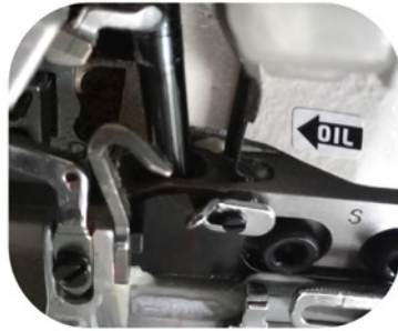
黑金刚滑杆 Black diamond coating slide bar
